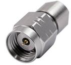
迈可博TM67-01-185M是一款DC-67GHz的超宽带同轴负载，在DC-67GHz内的驻波小于1.4:1。该负载具备1W的连续波功率容量及-55~+125°C的超宽工作温度范围，是测试、雷达、通信等各种应用的理想选择。
